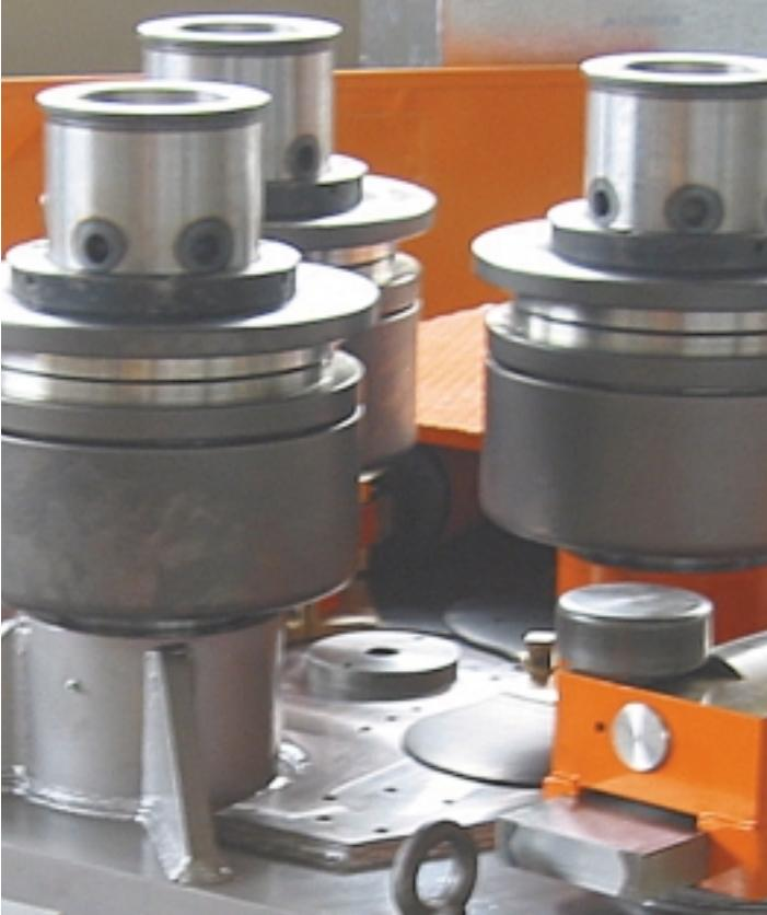
*La dotation standard se compose d'une série de galets modulaires, adaptés au cintrage de la plupart des profilés commerciaux d'usage commun, tels que plats, cornières, tubulaires carrés et rectangulaires, fers à T, fers à U, poutrelles IPE/IPN/HE.*
